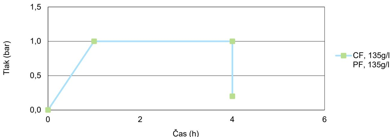
Cykly předúpravy mohou být přizpůsobeny dle procesu lisování, hustoty a geometrie dílu:
