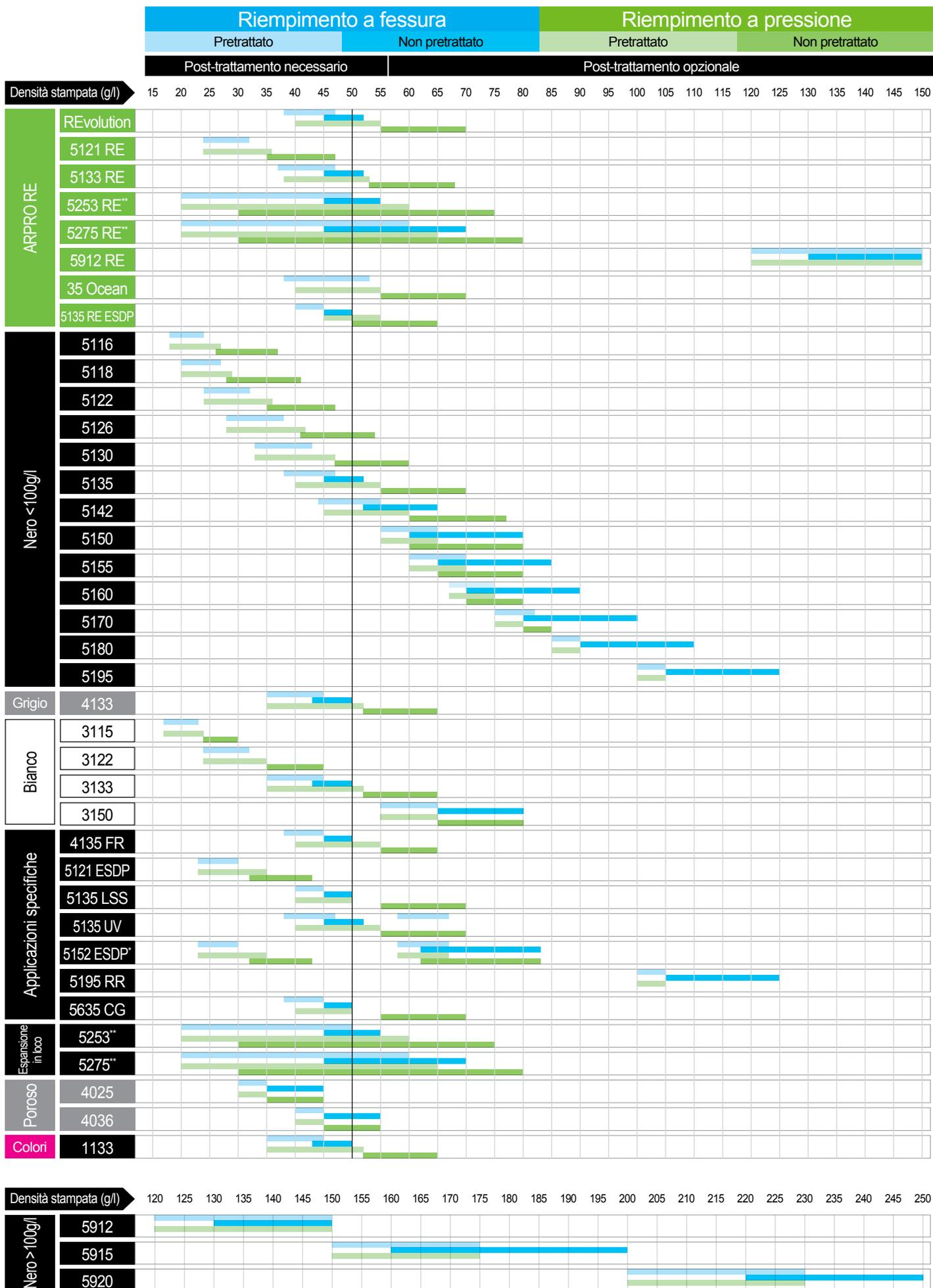
\*ARPRO 5152 ESDP è anche progettato per l'espansione in loco per ridurre le densità di bulk, a partire da 20g/l.
