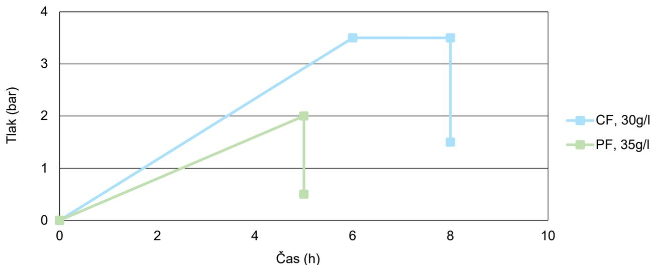
Cykly předúpravy mohou být přizpůsobeny dle procesu lisování, hustoty a geometrie dílu:
