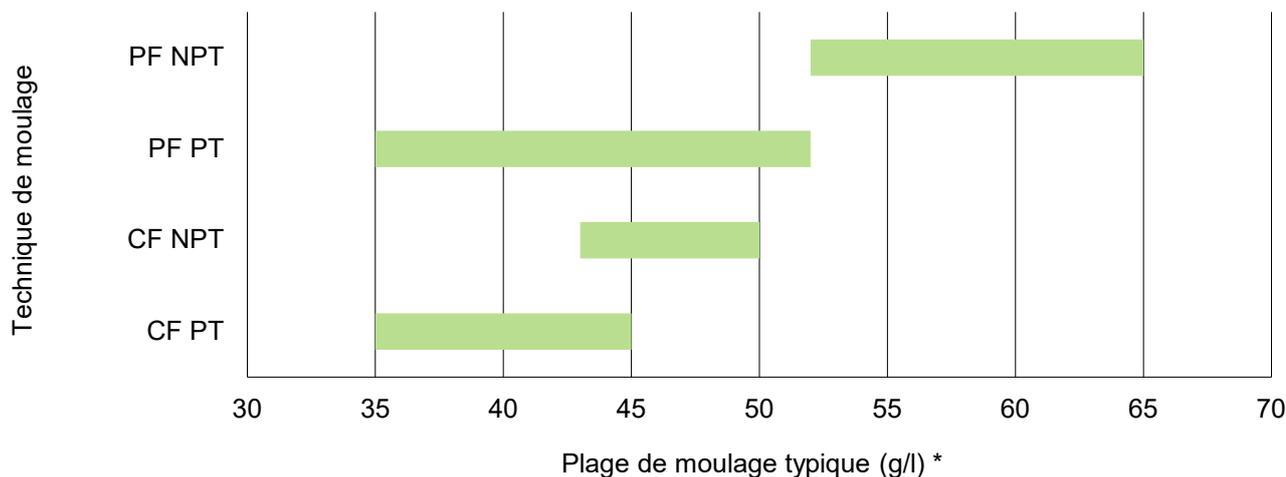
\* Le retrait, l'aspect de surface et la durée du cycle sont influencés par les paramètres du procédé, la disposition des outils et des équipements et la géométrie des pièces.
