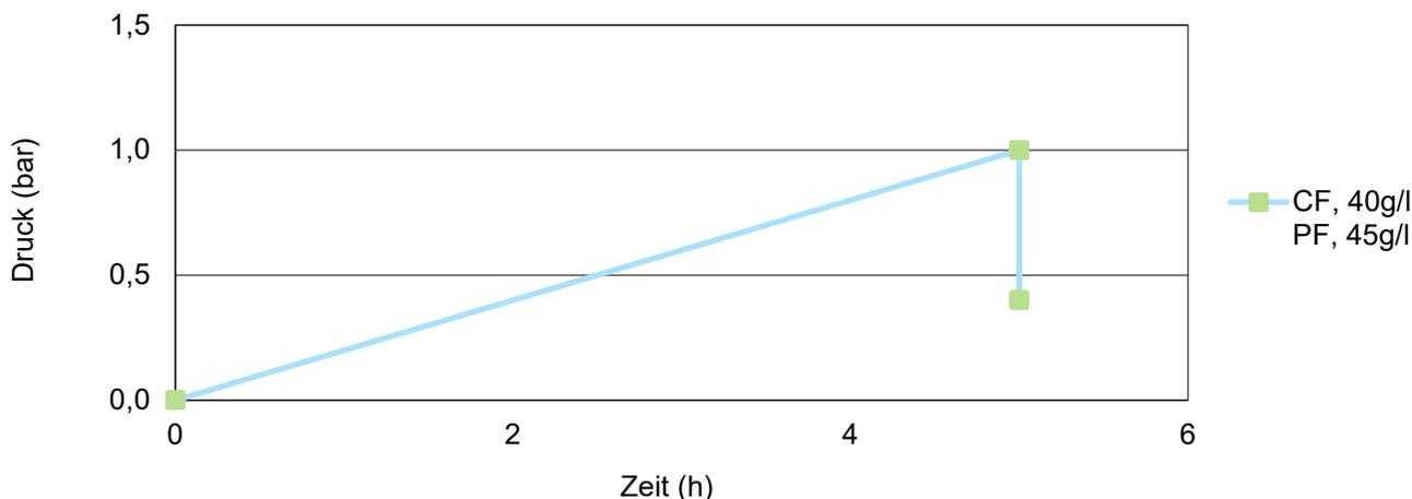
Vorbehandlungszyklen können je nach Formgebungsprozess, Dichte und Teilegeometrie angepasst werden: Ein überhöhter Druck in den Zellen kann zu Problemen bei der Verschweißung führen. Senken Sie in diesem Fall die Dauer, den Druck oder die Temperatur, um eine bessere Verschweißung zu erreichen.
